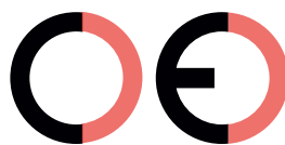
Faux marquage CE (trop éloigné)
